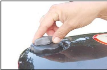
1. Lösen Sie die Entlüftungsschraube auf dem Tankdeckel.
