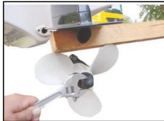
1. Überprüfen Sie jedes Propellerblatt auf Beanspruchung und Erosion.
