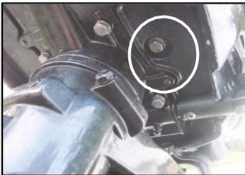
2. Bereiten Sie einen geeigneten Behälter vor, der eine größere Menge Öl aufnehmen kann, als im Motor vorhanden ist. Lösen und entfernen Sie die Ablassschraube, während Sie den Behälter unter die Ablassschraube halten, öffnen Sie den Öleinfülldeckel, warten Sie, bis das Öl vollständig herausgelaufen ist. Wischen Sie sofort vorbeigelaufenes Öl wieder auf.
