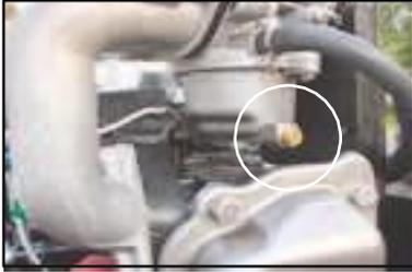
4. Befüllen Sie Motor mit frischem Motoröl
