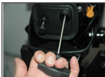
7. Ziehen Sie langsam an der Startleine, bis Sie einen Widerstand spüren. Jetzt ziehen Sie einmal kräftig direkt an dem Knebel und starten den Motor. Ziehen Sie nur kurz und ziehen Sie **MAXIMAL** bis zur Hälfte mit kurzen und schnellen Zügen. Wiederholen Sie diese Schritte einige Male, falls der Motor nicht anspringen sollte.
