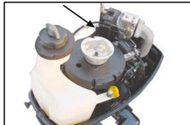
3. Entfernen Sie den Startmechanismus, nachdem Sie die drei Schrauben entfernt haben.
