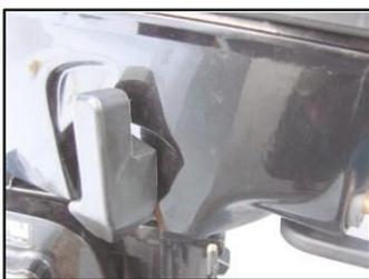
1. Schalten Sie den Schalthebel auf Neutral und richten Sie den Motor nach vorne aus.
