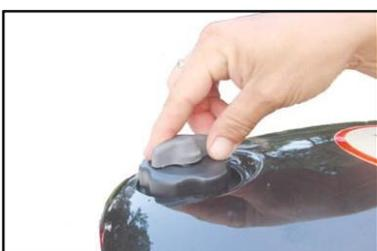
3. Schließen Sie das Luftventil auf dem Tankdeckel.
