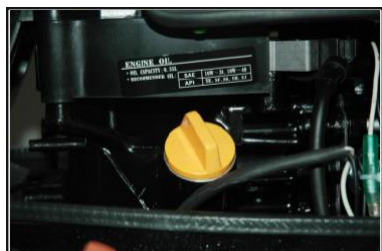
1. bouchon de remplissage d'huile
